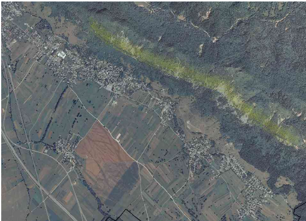
Slika 12: Območje možnega plazenja nad črto Žirovnica – Rodine
