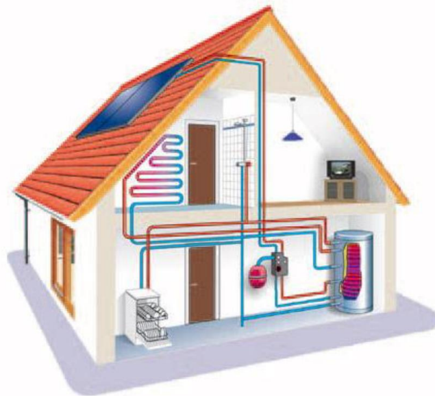
Slika 11-10: Namestitev solarnih kolektorjev na streho hiše (vir: )
