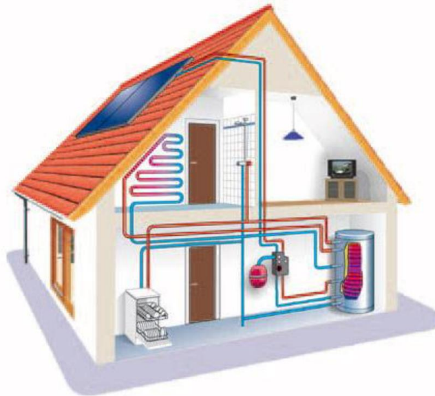
Slika 11-10: Namestitev solarnih kolektorjev na streho hiše (vir: )
