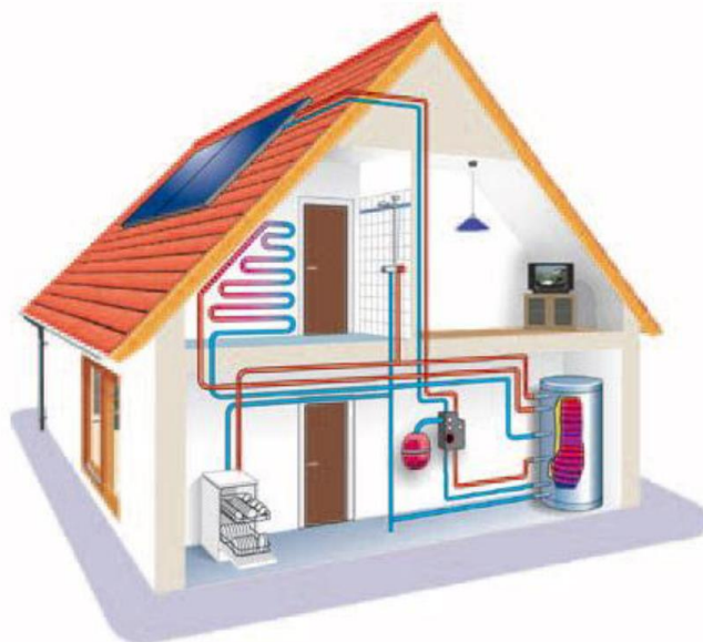
Slika 9-10: Namestitev solarnih kolektorjev na streho hiše
