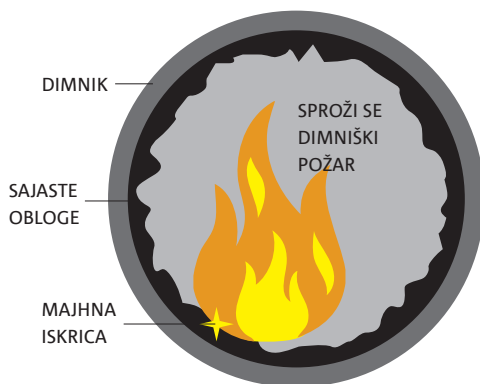
Slika 1: Nastanek dimniškega požara
