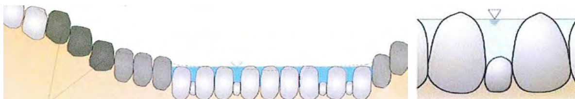
Slika 8: Shematski prikaz praga iz nepravilne kamnite zložbe. Med kamni so manjše višinske razlike za prehod vodnih organizmov.
