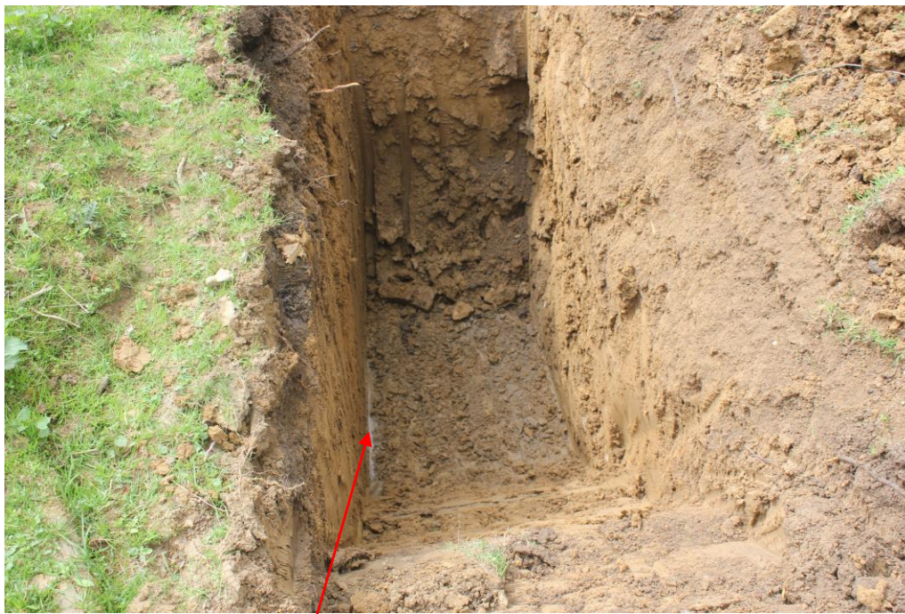
Na stiku z laporjem pojav vode
