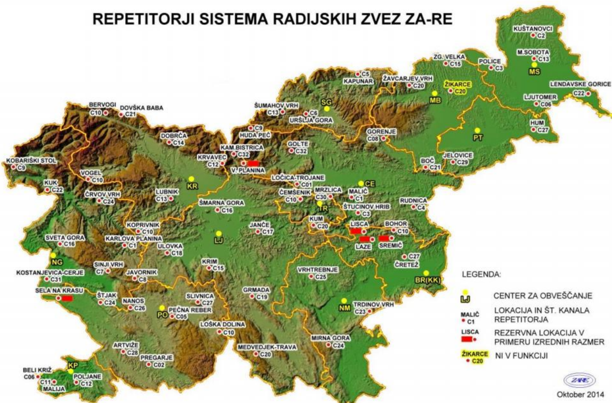
Slika 4: Repetitorske postaje s kanali sistema ZA-RE
