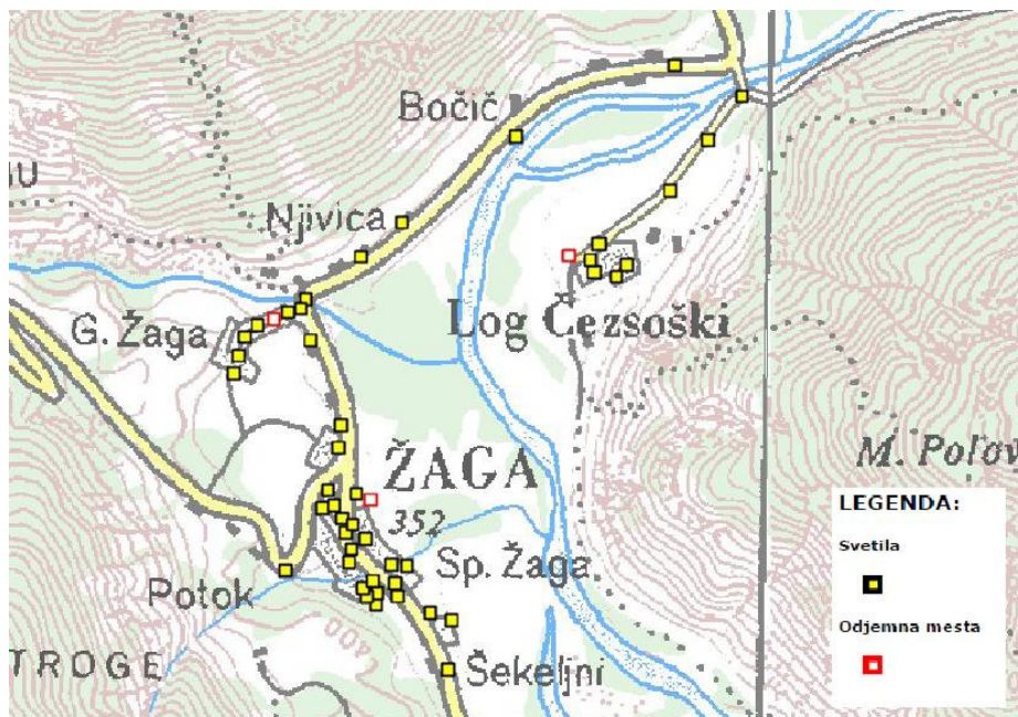
Slika 35: Potek javne razsvetljave v naseljih Žaga in Log Čezsoški (PISO, 2011)
