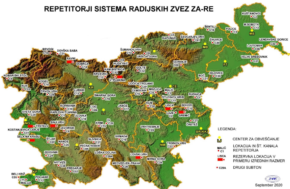
Slika 3: Repetitorske postaje s kanali sistema ZA-RE
